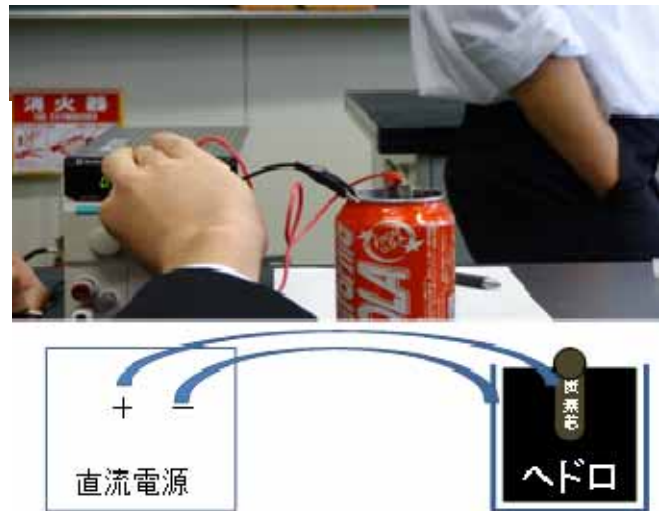
図7 上側は充電しているときの実験の様子、下側は充電しているときの模式図
