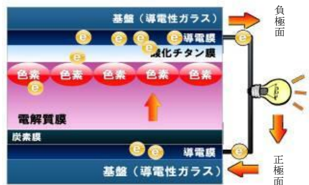
図1 色素増感太陽電池の構造
