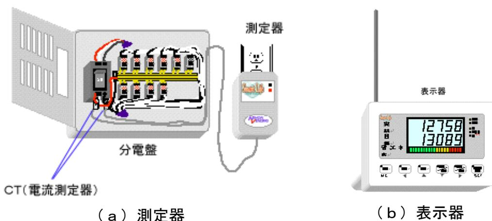
各家庭の分電盤での電圧と電流を測定して消費電力を算出し、その結果を表示器に無線で送信する。この他、個別機器1台の測定装置もある。
