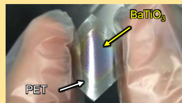
フレキシブル基板上のBaTiO 3 エピタキシャル薄膜 電学論C139, 211 (2019) (近畿大・西川博昭)
