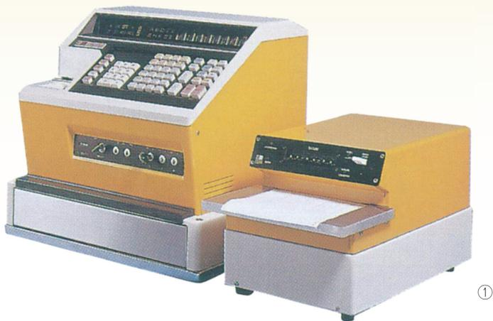
マイコンレジスタ BRC-32CF-GS は、世界で初めてマイコンチップを搭載した高性能電子レジスタです。東京電気㈱（現東芝テック㈱）は、創業したばかりのインテル社が開発した4ビットマイコンチップをいち早く取り入れることにより、従来の電子レジスタに比較して格段の小形化、高性能化、高機能化を図った電子レジスタを1972年に開発し翌1973年（昭和48年）に販売開始しました。
