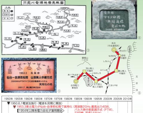
23回線, 百長144km) ▼1959.12中央電力協議会の無線局認可(広域運営用回線へ適用) 電力保安 ▼遠隔監視制御・無人化,系統保護 通信用 ▼2ルート化 ▼デジタル化 ▼回線ニーズ多様化 マイクロ波 無線 導入期 デジタル化 大容量化 拡大期 高信頼度化 の変遷 デジタル (Mbps) アナログ (回線) 600 208 960 104 240 52 1.5 3 19 32 39 60 ▼1976トランジスタ 1953 1967バラクタダイオード ▼1984電界効果トランジスタ (FET) 送信 板極管 デバイス (2GHz) の変遷 **V**1957 クライストロン(7GHz)
