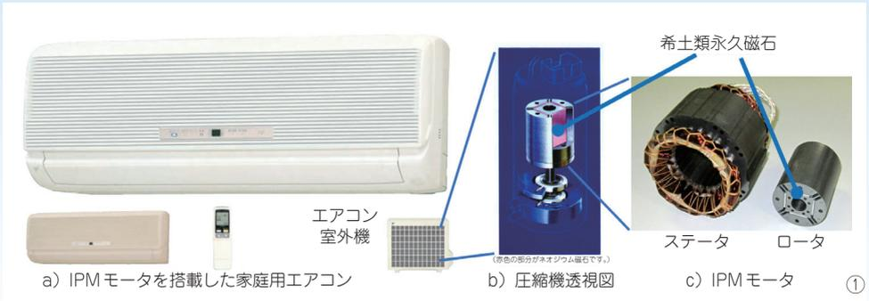
エアコンの快適性を実現するためには、最も運転時間の長い中低速運転から短時間で冷暖房を行う高速運転まで幅広い運転領域に対応する必要があります。しかし、従来の誘導電動機や、永久磁石をロータの表面に配置したSPMモータでは、高速運転を実現するために中低速運転の効率を犠牲にする必要がありました。そこで、ダイキン工業および大阪公立大学は、ロータに希土類永久磁石を埋込み、磁石トルクだけでなくリラクタンストルクを併用できるIPMモータと位置センサレス電流ベクトル制御技術を組み合わせることで、中低速運転を犠牲にすることなく、低速から高速まで幅広い速度範囲の消費電力を低減することに成功しました。
