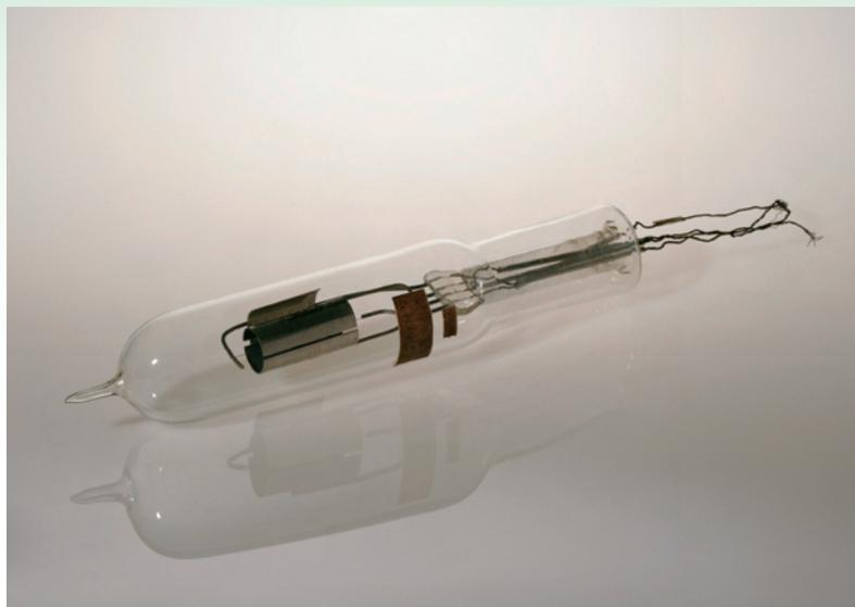
1922年、東北帝国大学（現・東北大学）を卒業した岡部金治郎は、同年より母校である東北帝国大学の講師となり、1927年、分割陽極マグネトロンを世界で初めて開発した。それまでにアメリカで開発されていた単陽極マグネトロンは、低効率でパワーが弱く波長の長いマイクロ波しか発振できなかったが、岡部が開発した分割陽極マグネトロンでは、効率のよい安定したマイクロ波（波長3cm、周波数10GHz）を発振することが可能となり、実用化に向けて飛躍的な進歩を遂げた。
