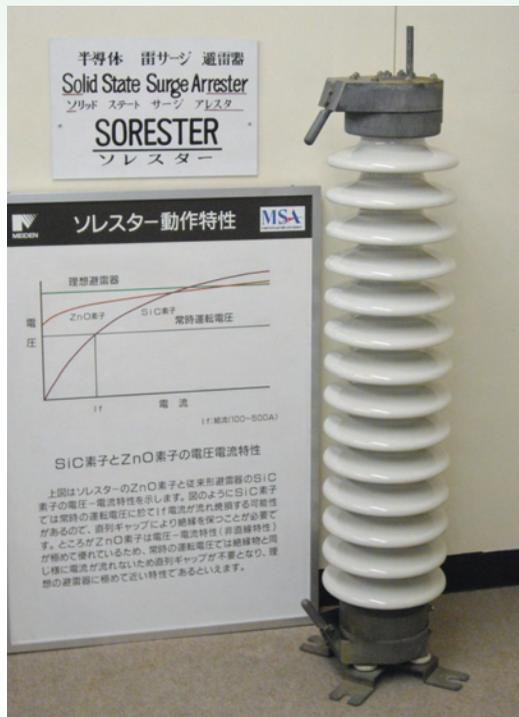
1967 (昭和42) 年、松下電器産業株式会社 (以下、パナソニック。現パナソニック株式会社) は、酸化亜鉛を主成分とする画期的な素子を発見した。株式会社明電舎 (現MSA株式会社) は、パナソニックと共同研究を開始し、ギャップのいらない高性能で信頼性が高い電力用酸化亜鉛形避雷器 (落雷などのときに発生する瞬間的な高い電圧から変圧器等の電力機器を守る装置) を開発、1975 (昭和50) 年に世界で初めて66kV 変電所にて使用開始された。
