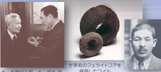
世界初のフェライトコアを 使用したコイル 左：加藤與五郎、右：武井 武 (フェライト発明当時)
