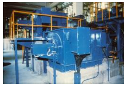
製紙プラントに適用した東芝製インバータ (左) と 500 kW 誘導電動機 (右)
