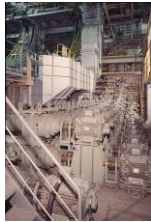
製鉄プラントに適用した安川電機製インバータ (左) と 11 kW～120 kW 誘導電動機 (右)
