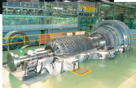
東新潟火力発電所全景 (中央部が 3-1 号系列) と 三菱重工業製 MW-701D 型ガスタービン
