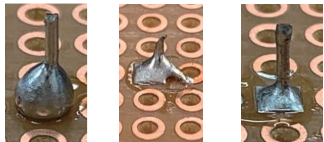
(a)イモはんだ (b)ショート (c)良いはんだ付け 図 2 良いはんだ付けと悪いはんだ付け
