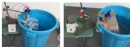
図 2 作製した様々な波力発電モデル。どのタイプも発電に至らなかった。
