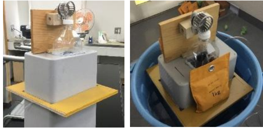
図6 評価実験の様子（おもりによって自重で水中に押し込まれる）
