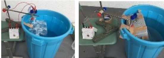
図2 作製した様々な波力発電モデル（どのタイプも発電に至らなかった）
