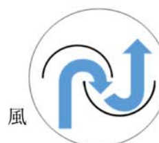
図1 サボニウス風車の仕組み
