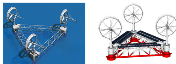
図3 開発されたレンズ風車を搭載した浮体構造
