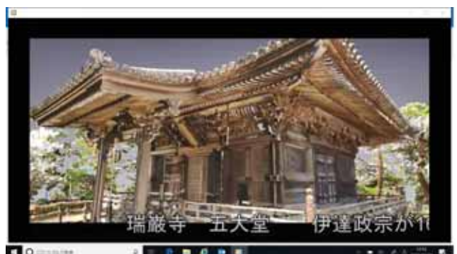
図7 3Dスキャナ撮影による点群データ(五大堂)
