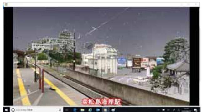
図6 3Dスキャナ撮影による点群データ(松島海岸駅)
