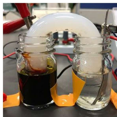
図1 塩橋を用いた電池
