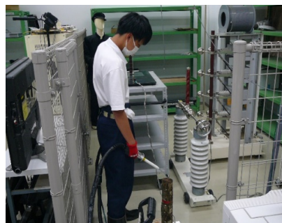
図3 電圧印加の様子
