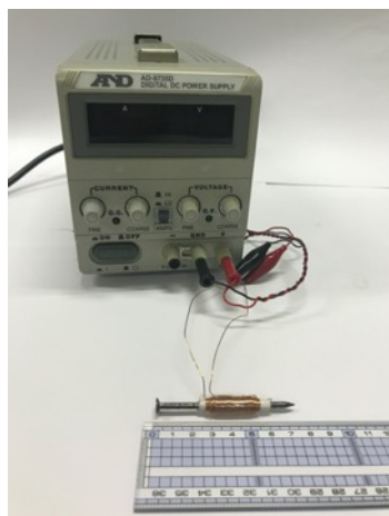
図7 製作した振動模擬試作機
