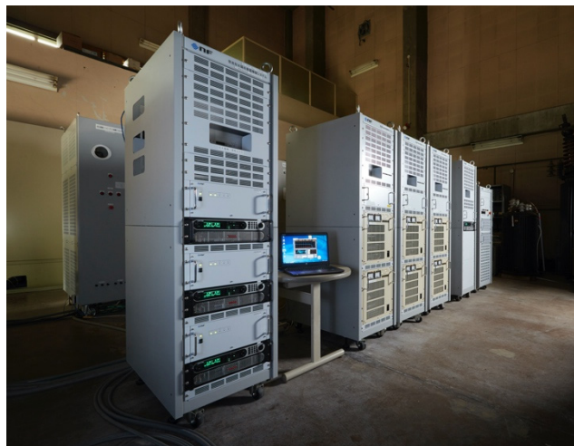
図1 次世代配電システムのシミュレータ
