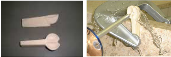
図4 マイクロペルトン水車のバケットと噴流実験
