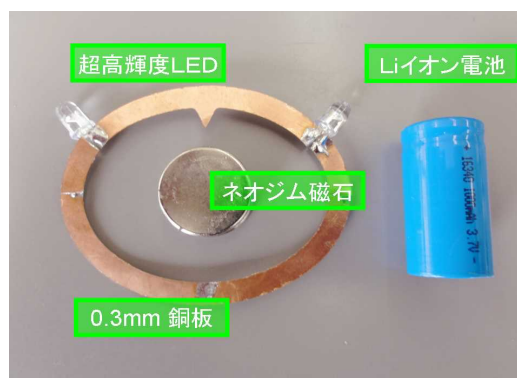
【図9】部品点数の大幅な削減に成功
