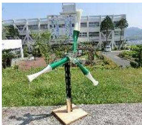
図1 スパイラルマグニウス風車(洲実開発品)
