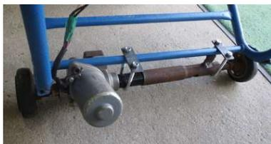
写真2 荷車下部に取り付けた走行用モーター
