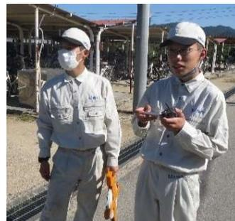
写真7 電波到達距離の測定 1
