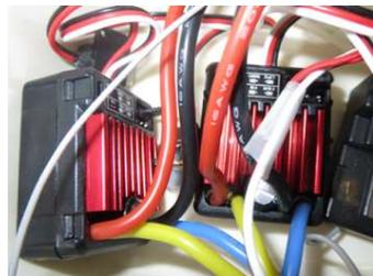
写真4 回転方向・回転速度の制御装置
