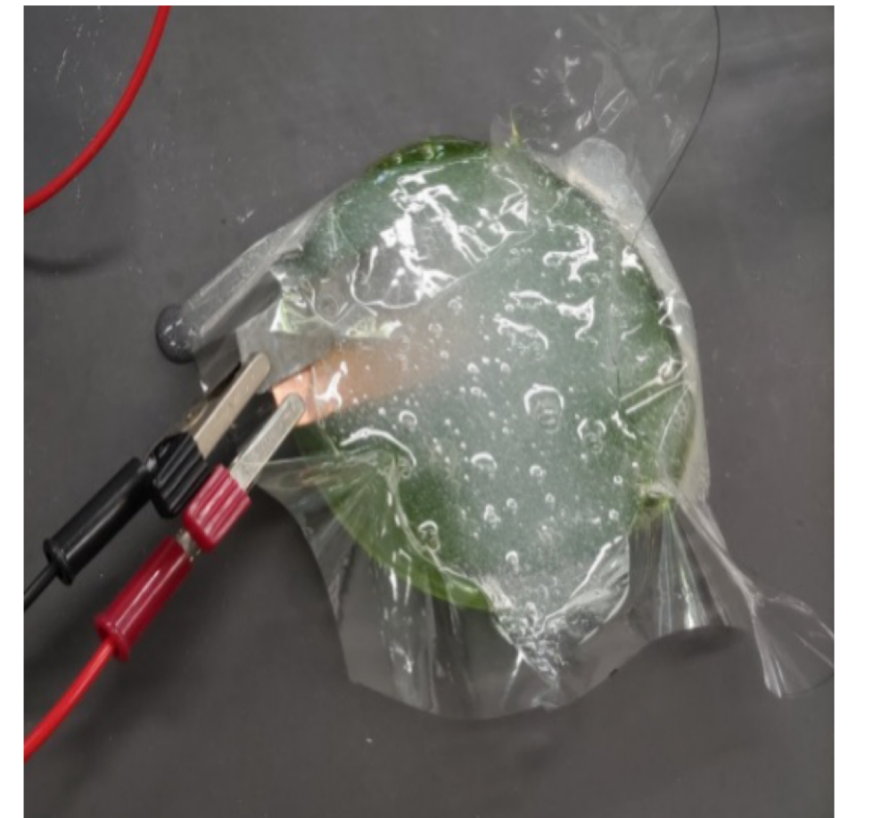
図3. スライム電池の組立て
