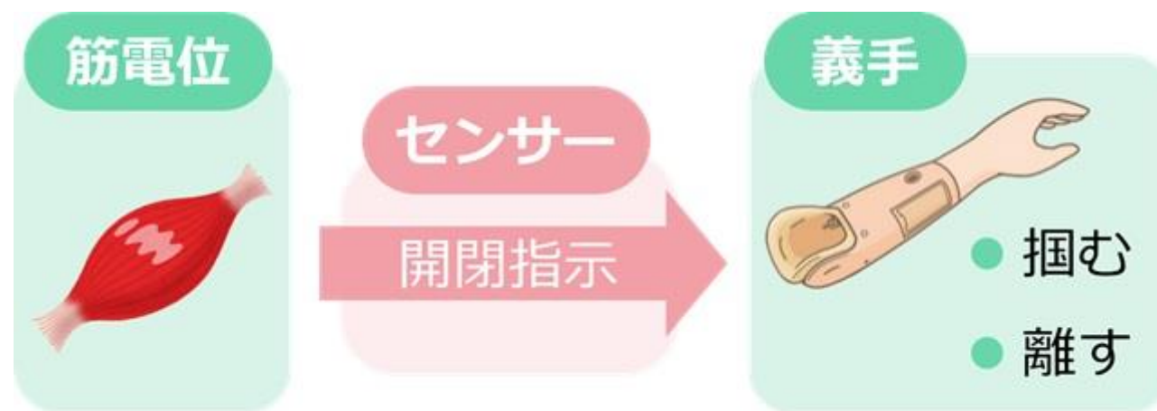
筋電義手の仕組み
