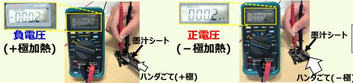
図15. ホットプローブ法によるpn判定<sup>[5]</sup>
