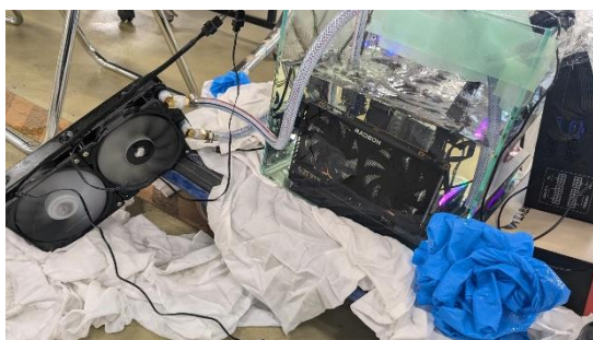
図5 実際に使用した循環式 PC
