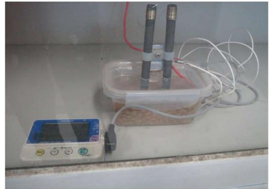
図4 納豆を測定中の実験装置
