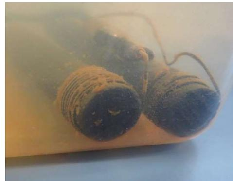
図9 スプリングに発生した錆(72時間後)
