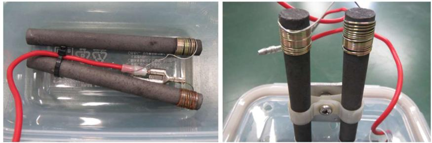
図3 マイナス側電極（左） プラス側電極（右）
