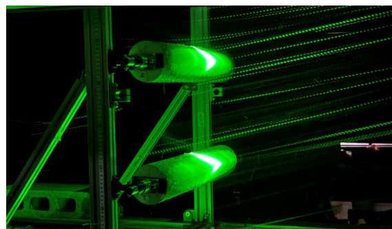
図3 着雪実験の様子（上下2段に設置した円柱への着雪状況および粒子の衝突特性をレーザーで可視化）
