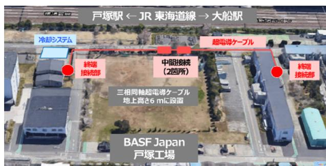
図 1 実証試験時の現地鳥瞰図 (BASF 戸塚工場)
