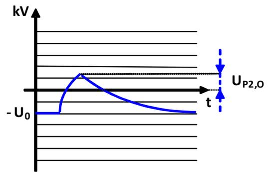
(c) LCC/VSC 逆極性 正極 開閉インパルス波形
